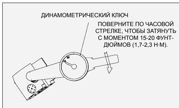
Момент затяжки седла клапана
