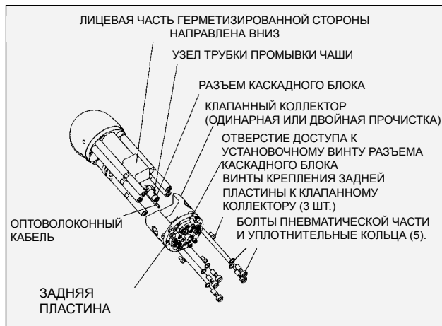
Снятие заднего клапанного коллектора
