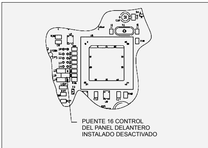
Figura 23: Ubicación del puente – Bloqueo de panel delantero
