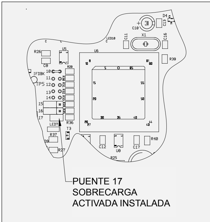
Figura 11: Ubicación de puentes - Activación de sobrecarga
