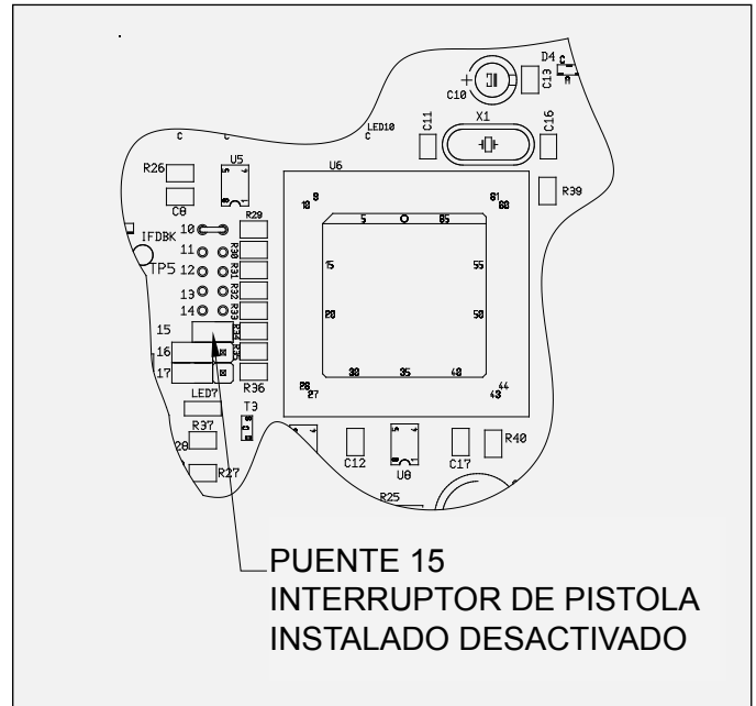
Figura 10: Ubicación del puente - Bloqueo del interruptor del aplicador
