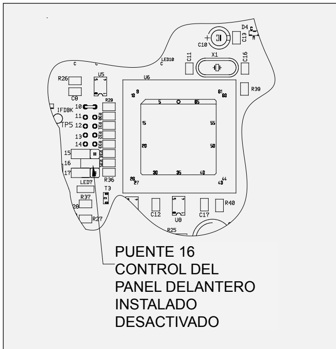
Figura 9: Ubicación de puentes - Bloqueo de panel delantero
