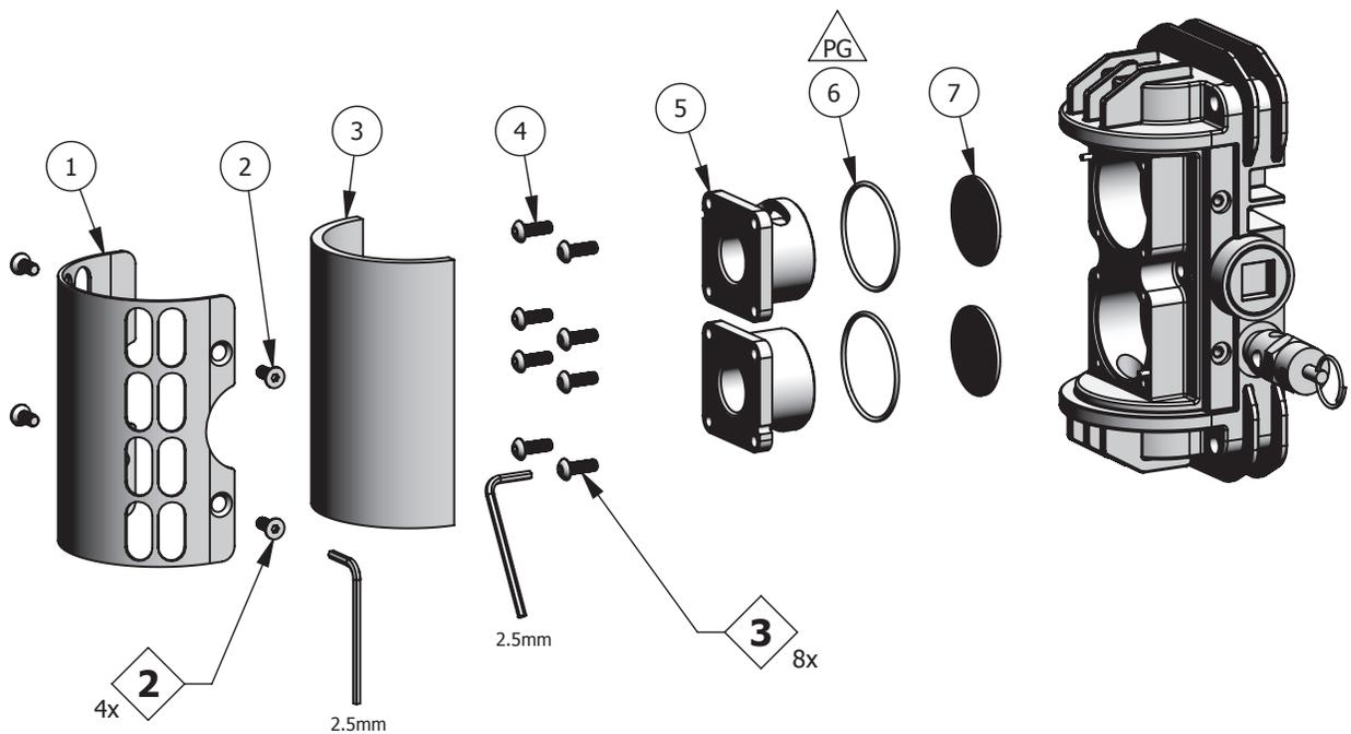
AX140S CONJUNTO DEL MOTOR DE AIRE – MANTENIMIENTO
